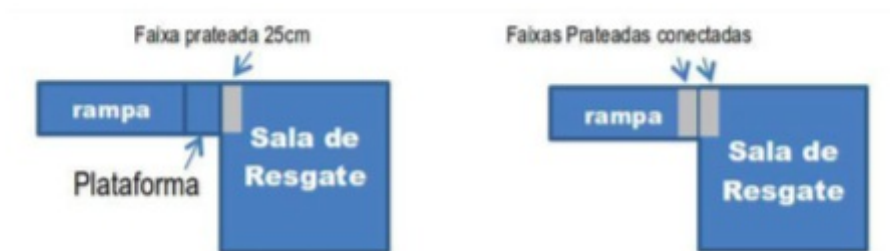
Figura 5 - Faixa prateada na entrada da sala de resgate com e sem plataforma.
